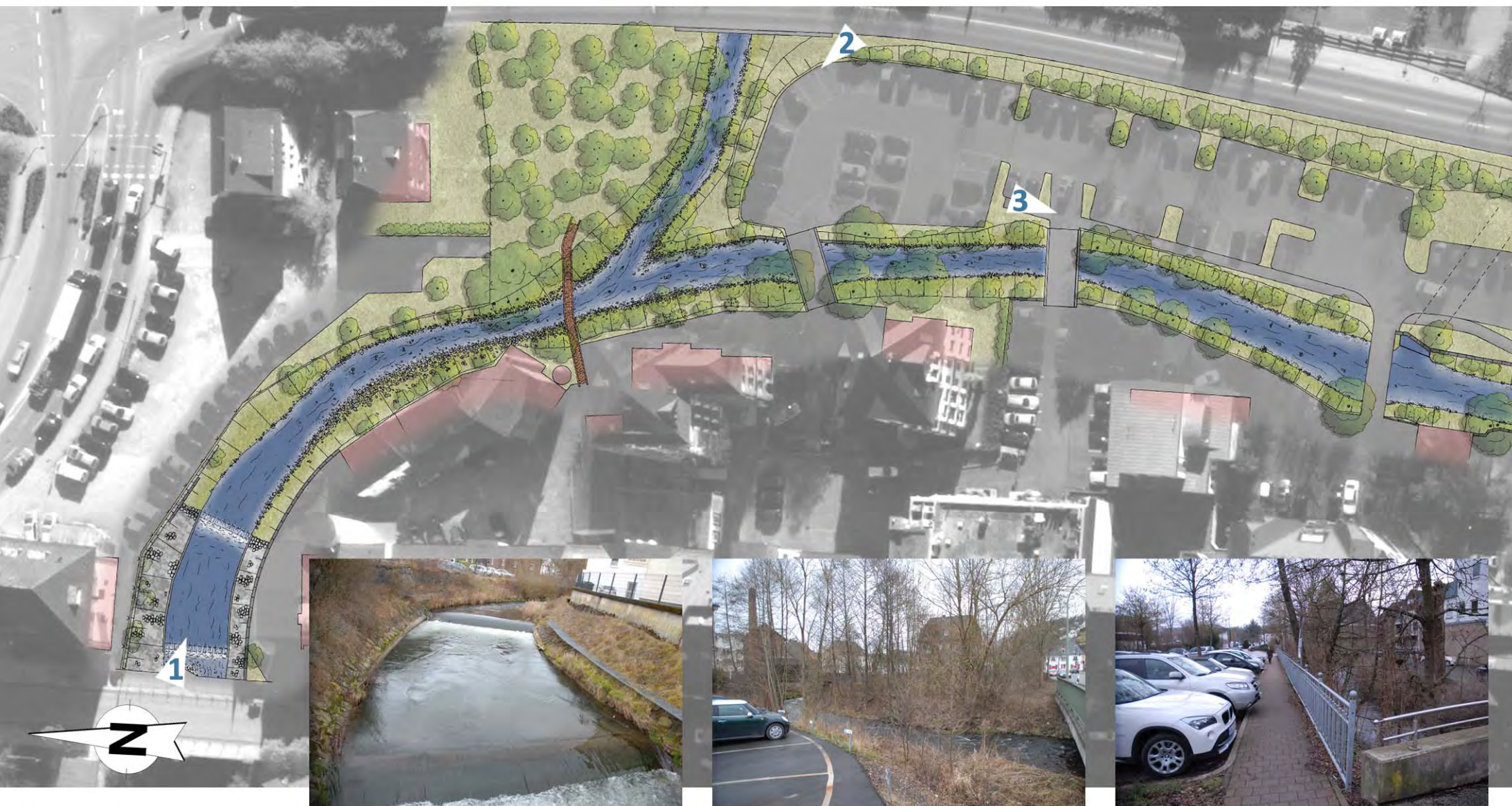
Abb. 1: Zwei Sohlenabstürze oberhalb der Postbrücke unterbrechen die aquatische Längsdurchgängigkeit der Röhre.
